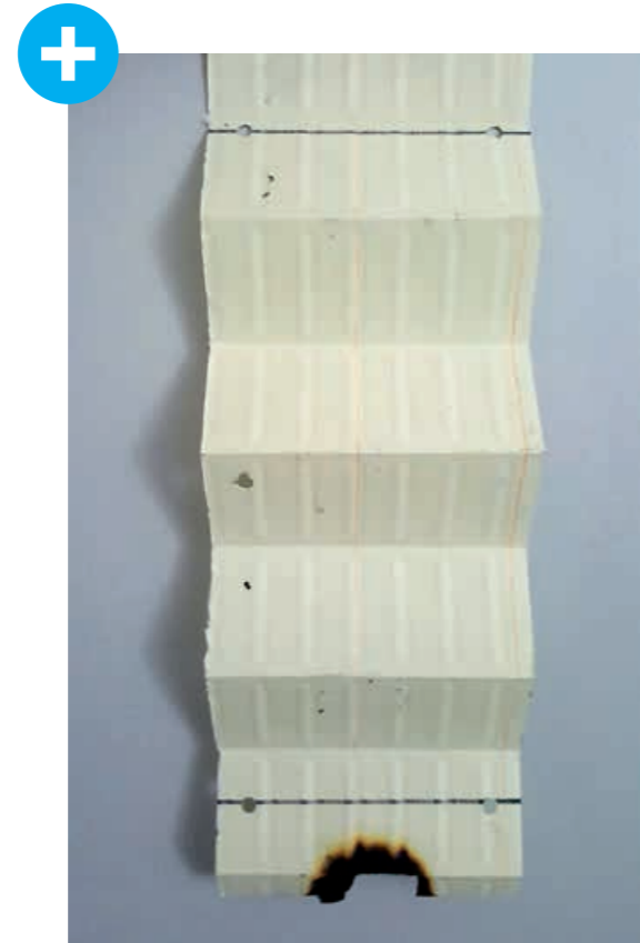
Der Mercedes-Benz Original-Luftfilter hat im Test nach Entzündung nicht weitergebrannt.
