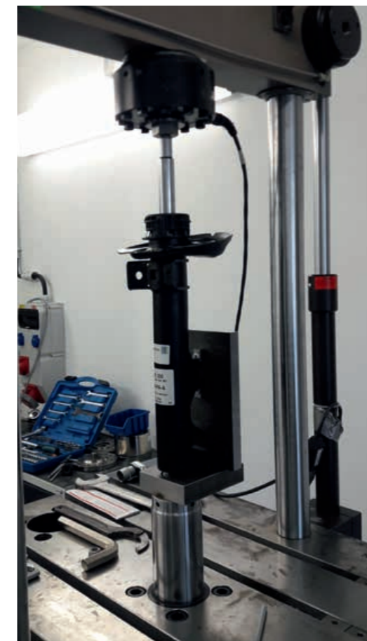
Prüfstand: 1-Achs-Hydropuls-Prüfstand an der TU Dresden
